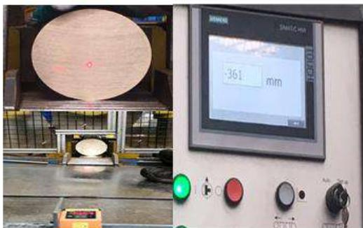
FIG. 5.27 Indicador de la dimensión de corte
