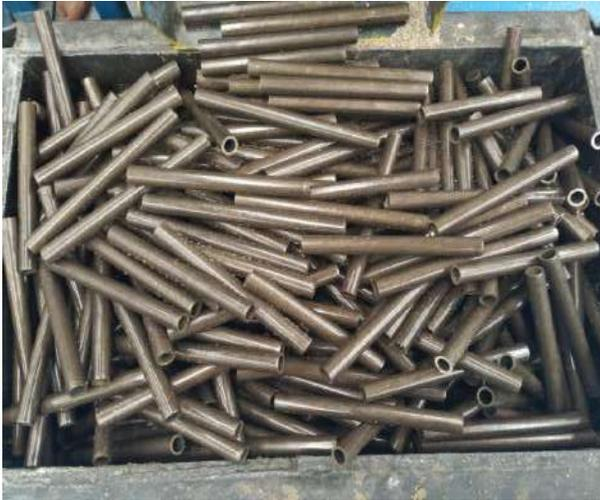
Fig. 5.21 Variación de despunte en trefilado
