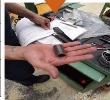
**Conclusion:** En la situacion actual cuando se va a colocar el tubo en el compresor, no entra y debemos **cortar 11.0 cm** del lado succion y **7.0 cm** del lado descarga (**18.0 cm. por cada compresor**), por lo cual se define que el estandar de corte actual de 40.0 cm genera desperdicio y **si es causa raiz.**
