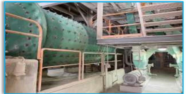
Foto No.22: Molino de Cemento 2
