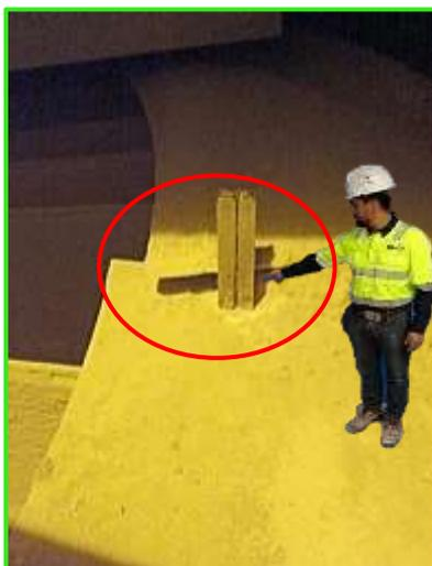
Foto 4: Guillotinas separadas del Separador
