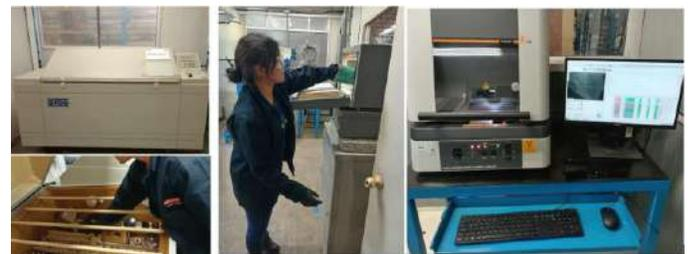
Figura 24. Pruebas de Laboratorio (Rocío salino, choque térmico y espesores).
