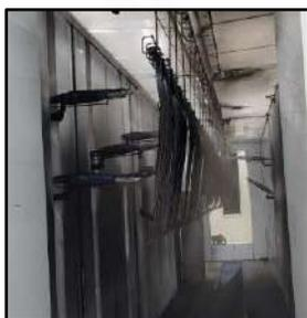
**Descripción detallada:** Ya sin piezas en cabina se debe activar la purga de pistola para evitar algún residuo de pintura en las pistolas que genere un defecto.
